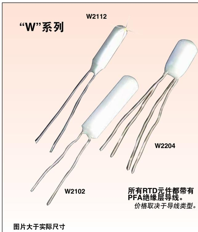
**W系列:** W系列元件是坚固耐用的圆柱形薄膜式陶瓷铂元件，它们可以在-50 ~ 600°C (-58 ~ 1112°F)温度范围内使用。这些元件配有直径0.38 mm (0.015")长度约为10 mm (0.4")的金-铂导线，它们可以减少陶瓷基片的应变。W系列元件有单元件和双元件配置，0°C电阻为100、200、400、500、1000和2000 Ω。这些元件的电阻与温度特性符合IEC751，由于0°C时的容差为±0.1%，因此其精度介于A级和B级要求之间。可以于在线技术参考部分找到电阻与温度表以及计算方程。
