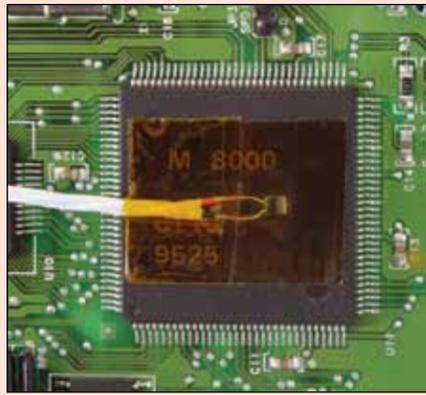
自粘传感器是在曲面或平面上“定位”安装的理想之选。粘贴在适当的位置上后，自粘传感器就会“一直”在需要监控温度的机床、电子产品、建筑或其它位置等应用中测量温度。
